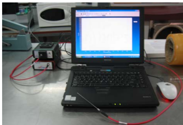
Figura 3. Colorímetro de fibra óptica
