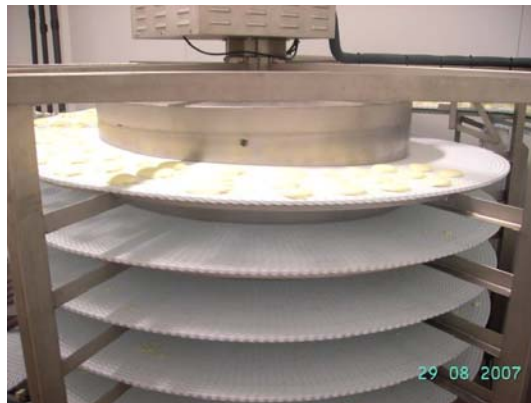
Figura 3. Túnel de refrigeración
