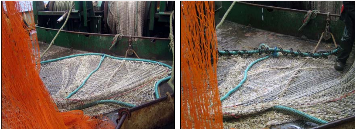
Figura 8. Detalles de burlón lastrado del arte OMEGA y lastre adicional de cadena
