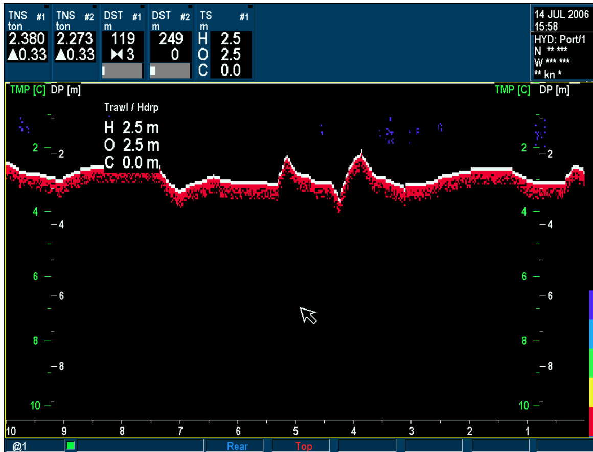
Figura 35. Registro de tensiones lance 2.6 (arte CLASICO 100 sin lastre)
