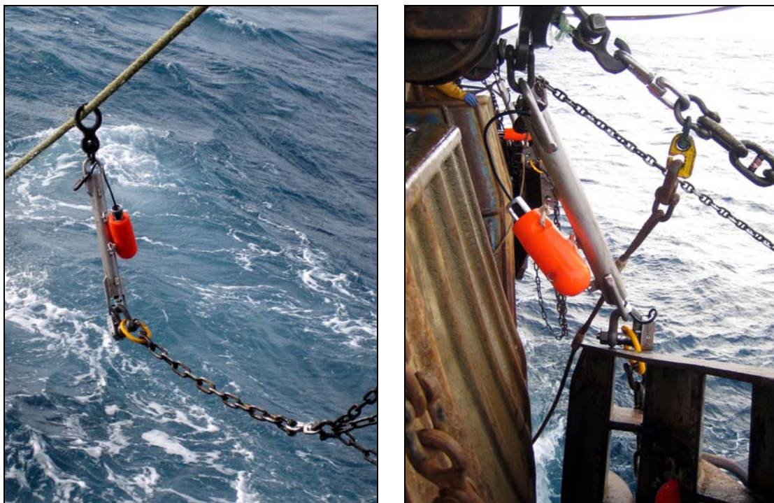
Figura 9. Instalación de sensores de tensión en la intersección del ramal de cadena del “pie de gallo” de la puerta y el gancho “ocho” que discurre por la malleta.
