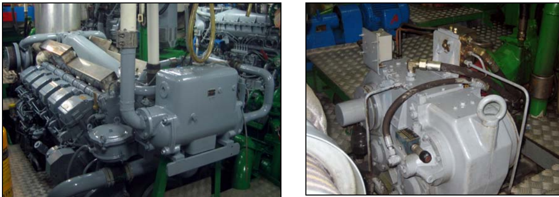
Figura 49 : Motor principal y reductora
