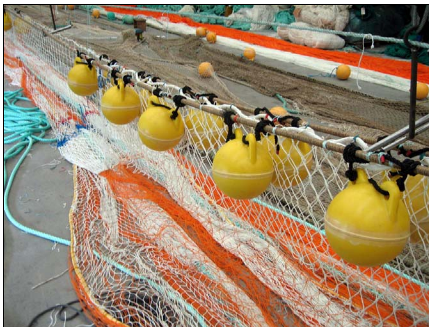
Figura 6. Detalles de la relinga de flotación: arriba, armado en la fábrica de redes INAS MUGICA de Berriatua (Vizcaya).
