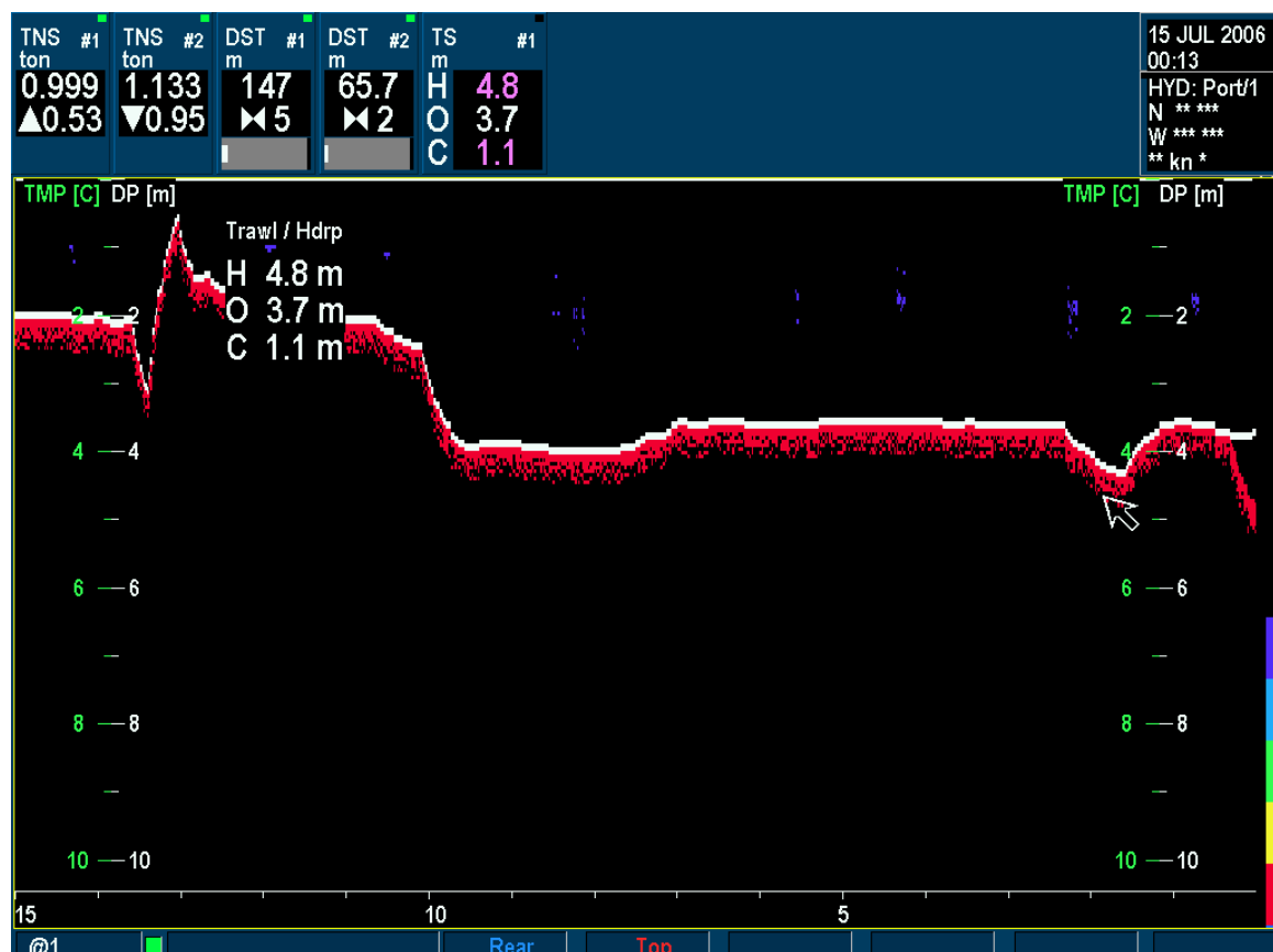
Figura 46. Gráfica del momento en el que se produce la rotura del arte.
