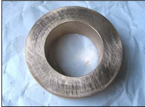
Figura 3: Disco metálico alojado en tambor inferior para evitar desplazamientos del resorte.
