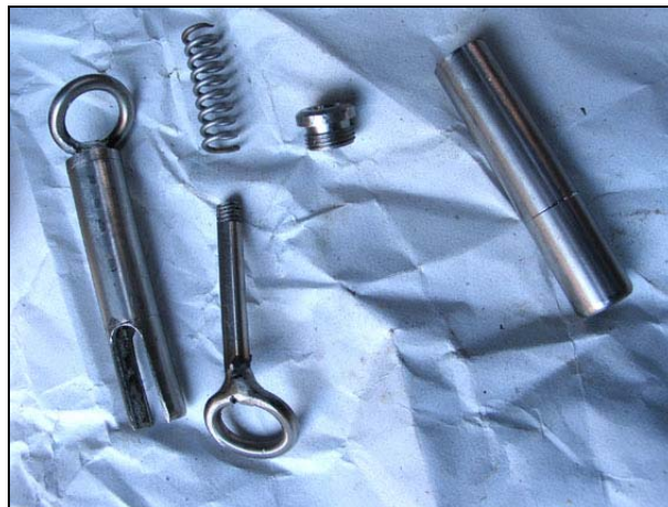
Figura 5: Despiece del nuevo diseño del tope metálico de la banda plástica.
