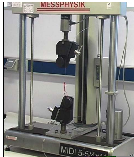
Figura 13: Detalle del nudo de un anzuelo montado en el monofilamento (izquierda) y máquina realizando el ensayo (derecha).
