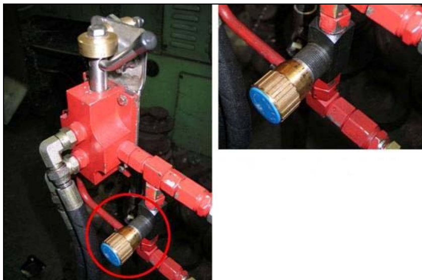
Figura 2. Válvula reguladora de velocidad del halador.
