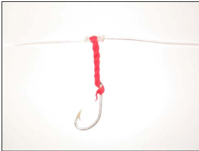
Figura 13: Detalle del nudo de un anzuelo montado en el monofilamento (izquierda) y máquina realizando el ensayo (derecha).
