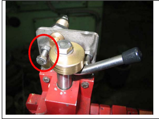
Figura 1. Accionador del halador y pernos de tope añadidos.
