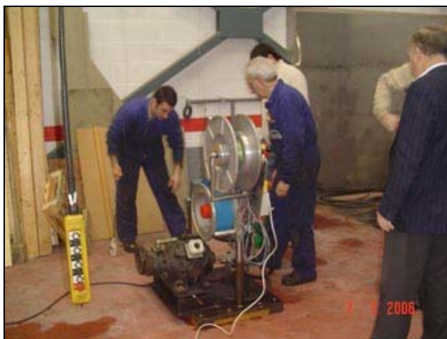
Figura 11: Halador automático en el banco de pruebas (izquierda) y montado a bordo del Urdaibai bat (derecha).
