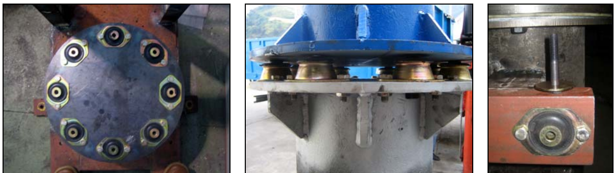
Figura 14: Medidas de protección contra las vibraciones "silenblock" en la base y unión del soporte con la borda.
