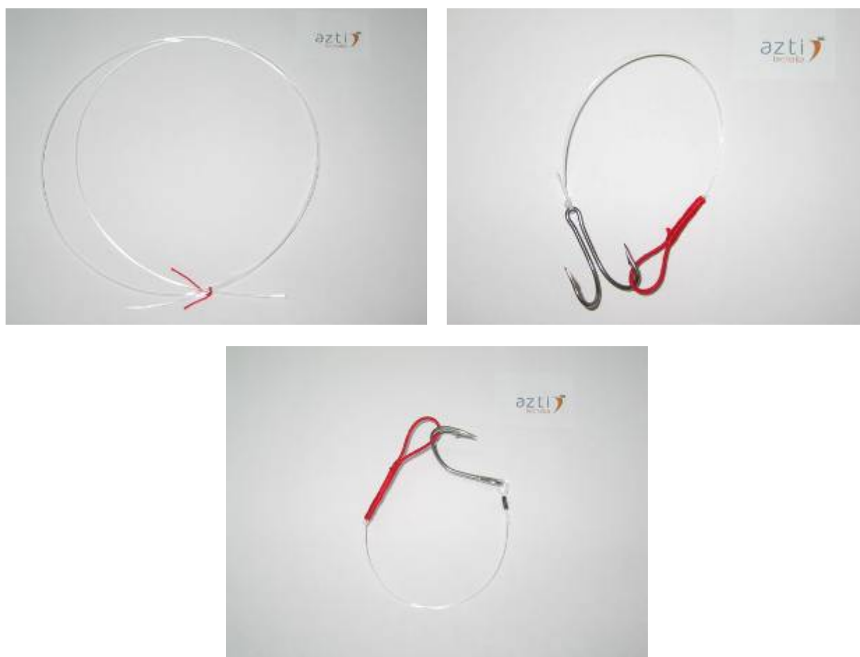
Figura 4. Imagen de las réplicas del aparejo de cacea a bonito. Sin nudo (Arriba izqda.), con nudo (Arriba dcha.) y con remache (Abajo).
