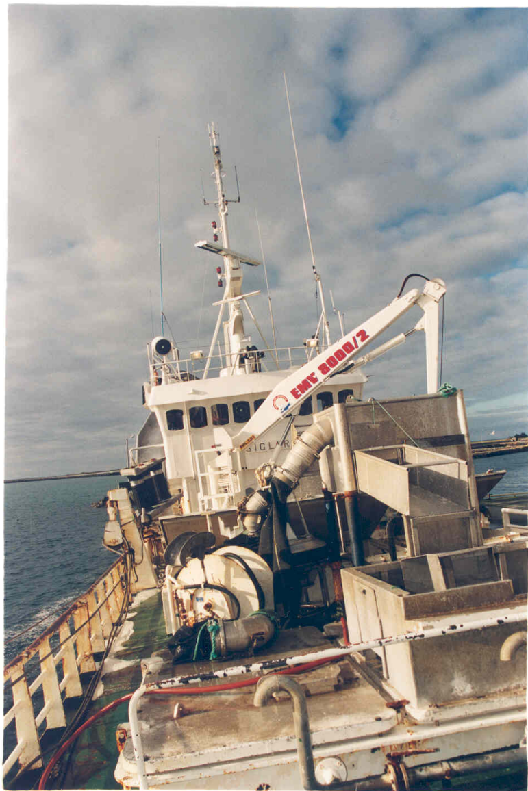
Figura 4: cubierta de barco cerquero noruego equipado con el sistema TRIPLEX
