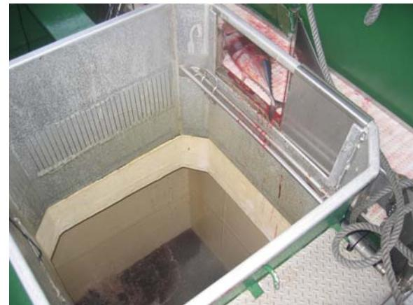
Según los cálculos termodinámicos para enfriar 6400 kilos de bonito a 26°C harían falta 1.700 kilos de hielo. En este caso hemos utilizado 2100 kilos de hielo además de ayudarle durante 45 minutos con el frío mecánico. El resultado es que aún utilizando más cantidad de frío de la teóricamente necesaria, el bonito está a 5°C. Esto quiere decir que tenemos una pérdida de frío sustancial en este vivero.
