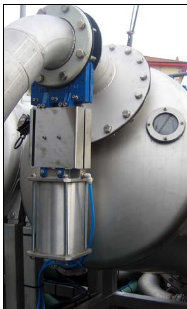
Imagen 10: válvula de tipo “guillotina” (izq.) y “clapeta” de goma (dcha.).
