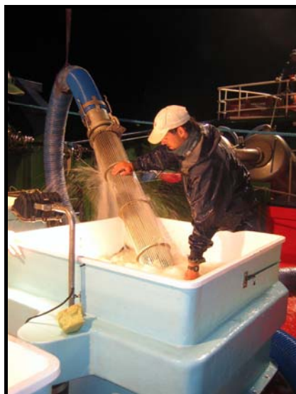
Figura 11: Tubo cilíndrico separador agua/pescado
