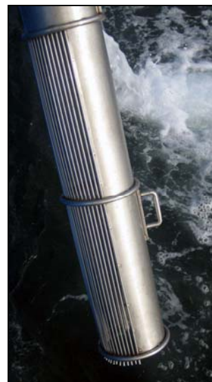
Figura 11: Tubo cilíndrico separador agua/pescado
