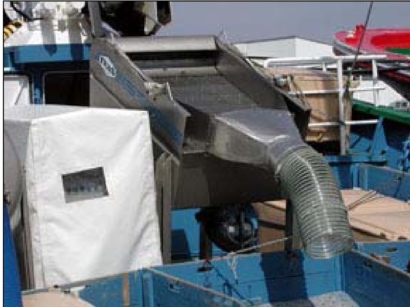
Figura 10: Separador de agua/pescado.
