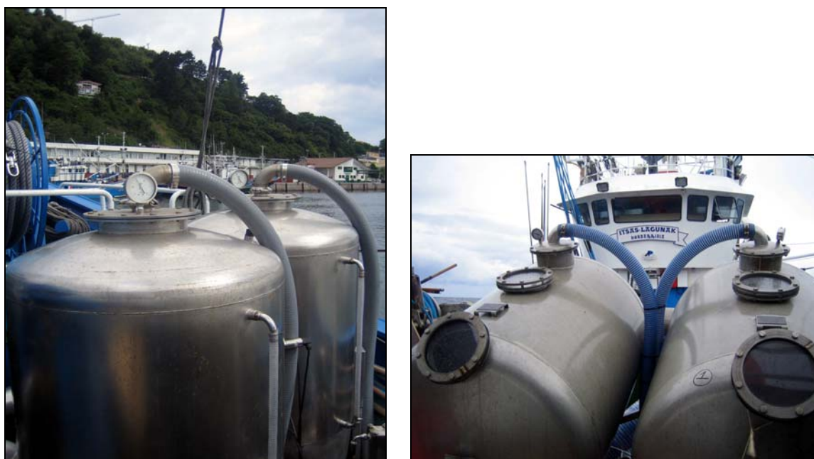
Figura 6: Cámaras de vacío en disposición horizontal (dcha.) y vertical (izda)
