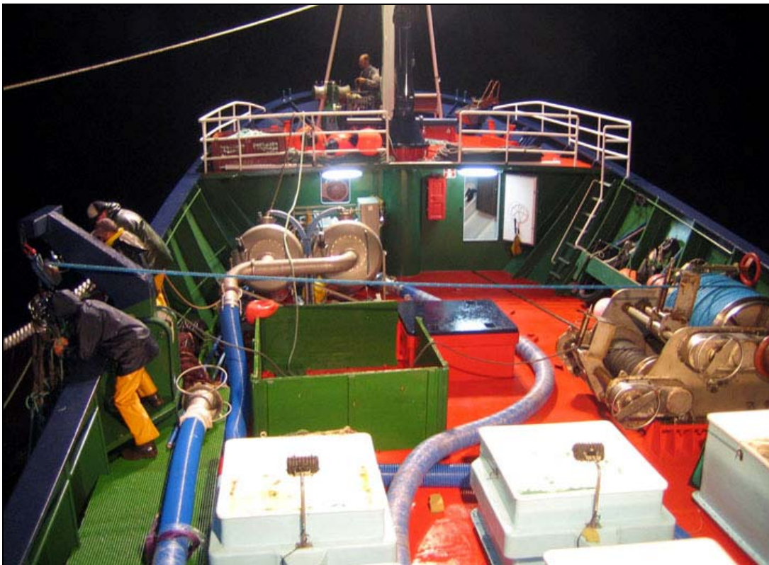
Figura 6: Vista general de la maquinilla automática de jareta
