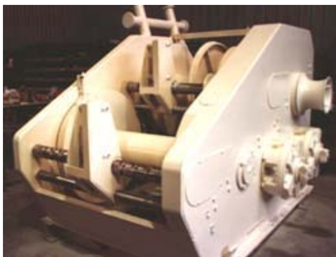
Figura 2: Maquinilla automática para virado de jareta
