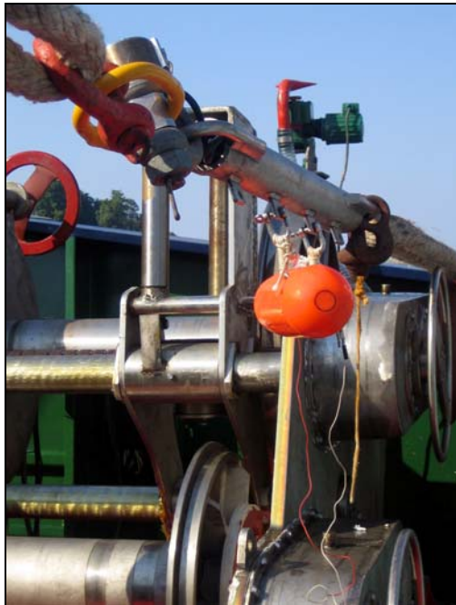
Figura 3: Sensor y grillete de tensión SCANMAR
