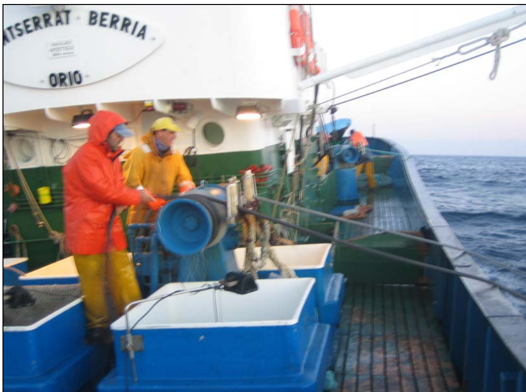
Figura 13: Virado de jareta con maquinilla tradicional
