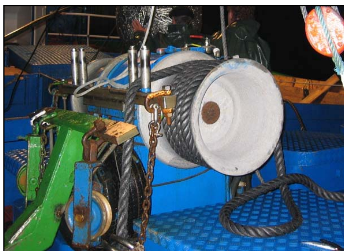
Figura 1: cabo de jareta arrollado sobre maquinilla tradicional
