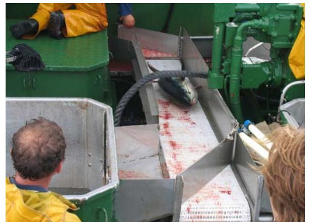
Una vez el pescado entra en el vivero, el sistema RSW (agua de mar refrigerada mecánicamente) o CSW (agua de mar enfriada con hielo) reduce rápidamente la temperatura del atún, favorecién la conservación y la calidad del mismo
