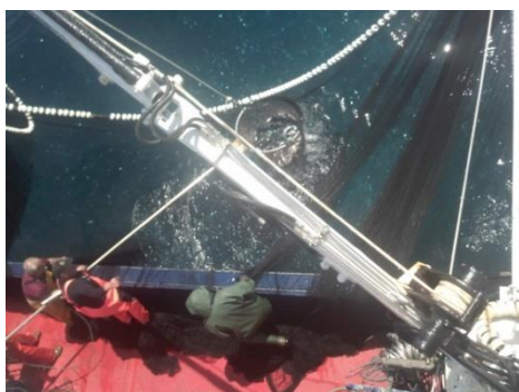
Salabardeo manual (izda.) Salabardeo mediante bombas de vacío presión (Dch.)
