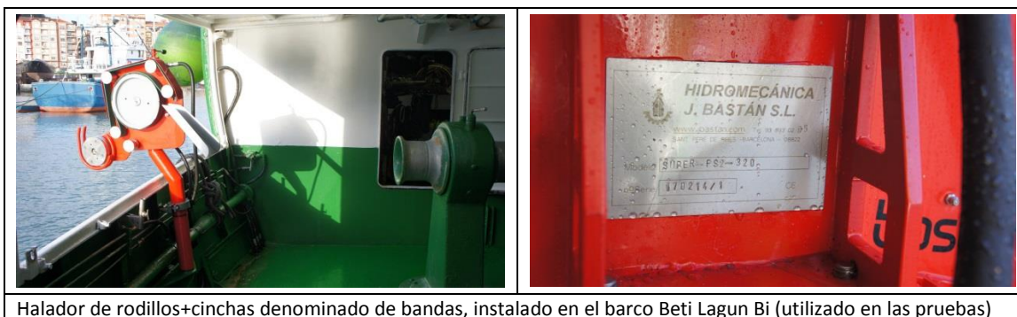
Halador de rodillos+cinchas denominado de bandas, instalado en el barco Beti Lagun Bi (utilizado en las pruebas)
