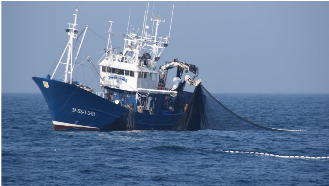
Halador de rodillos suspendido (Triplex/grúa): virado del arte
