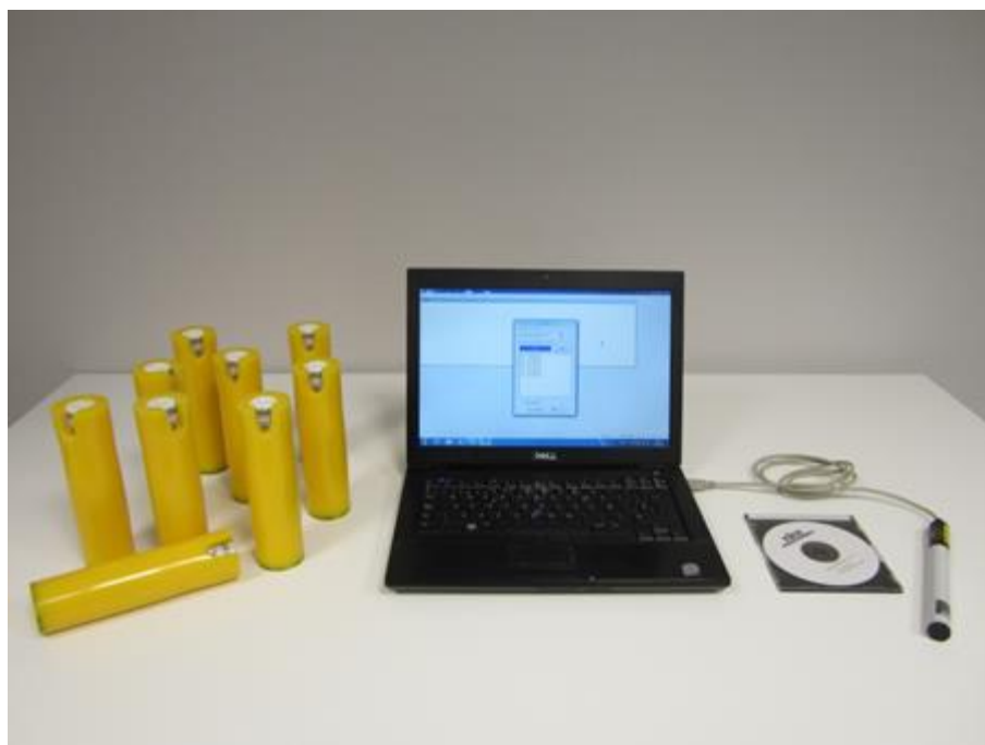
Equipo NKE de monitorización de la red de cerco.
