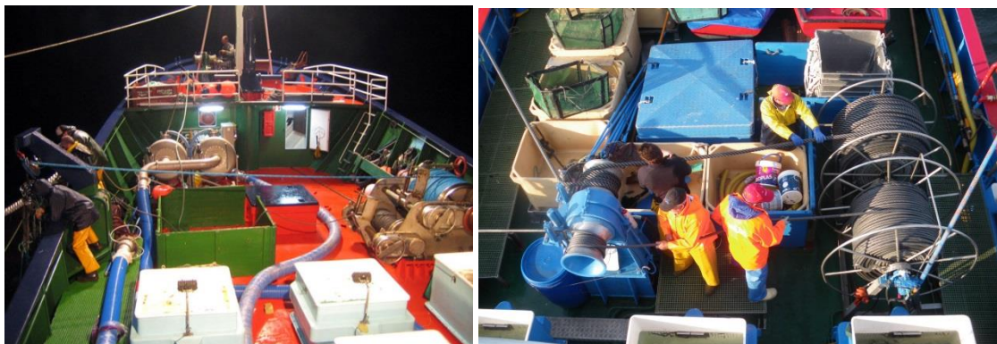
Maquinilla de Cerco (Izda.) y Chigre y Carreteles Estibadores de jareta
