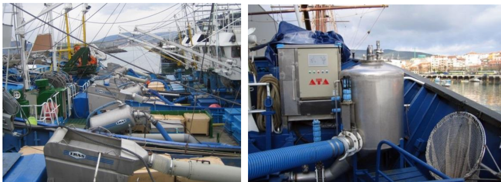
Bombas de vacío/presión; Vista general de la flota de Getaria (izda) y detalle del equipo en buque de cacea (dcha)
