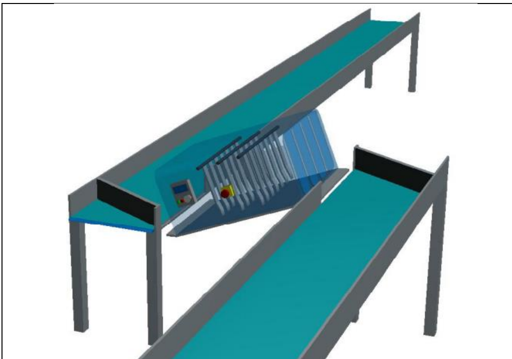
Montaje del sacrificador sobre la rampa: entre las dos cintas pero sin tocarlas
