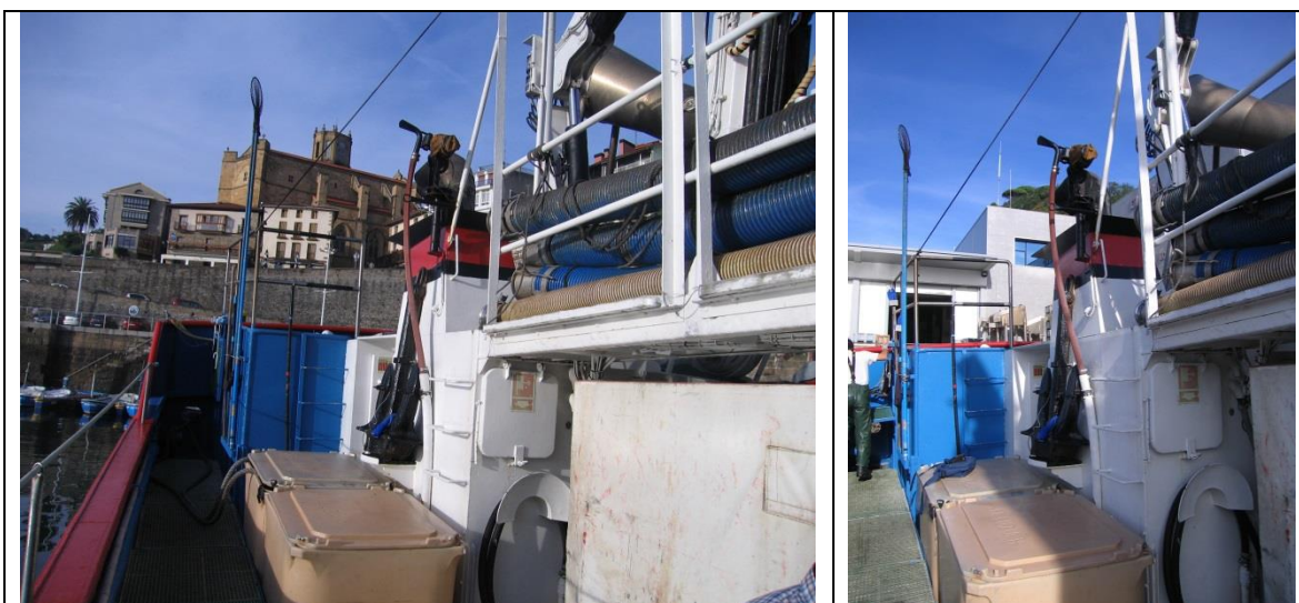
Situación de la chiparra (aspersor de agua salada) sobre la zona de la cinta de popa
