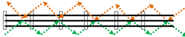
Figura 2. Ejemplo de muestreo de línea eléctrica área de evacuación mediante recorridos en zigzag.
