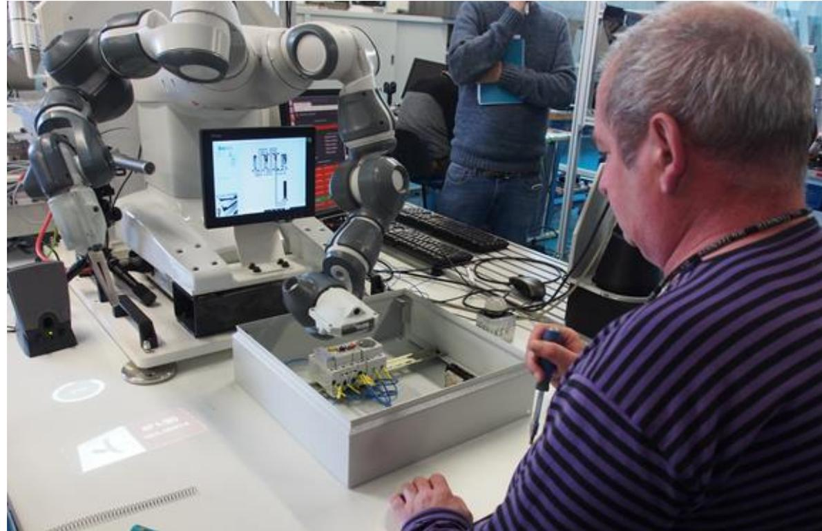
Figura 1: Trabajador con discapacidad intelectual montando un armario eléctrico en colaboración con un cobot. El robot está revisando los cables que el operario acaba de conectar e informando al trabajador si se encuentra un error, que tendrá la oportunidad de corregirlo.
