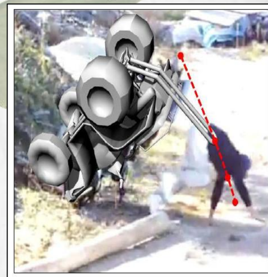
Reproducción de un vuelco delantero en el que la estructura de protección atrapa al operador. (Tomado de Vitrano -2013-).
