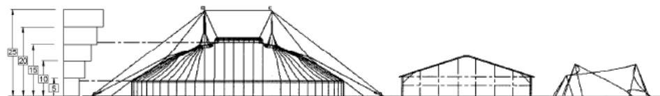
Figura 1 – Aplicación de las cargas debidas a la acción del viento
