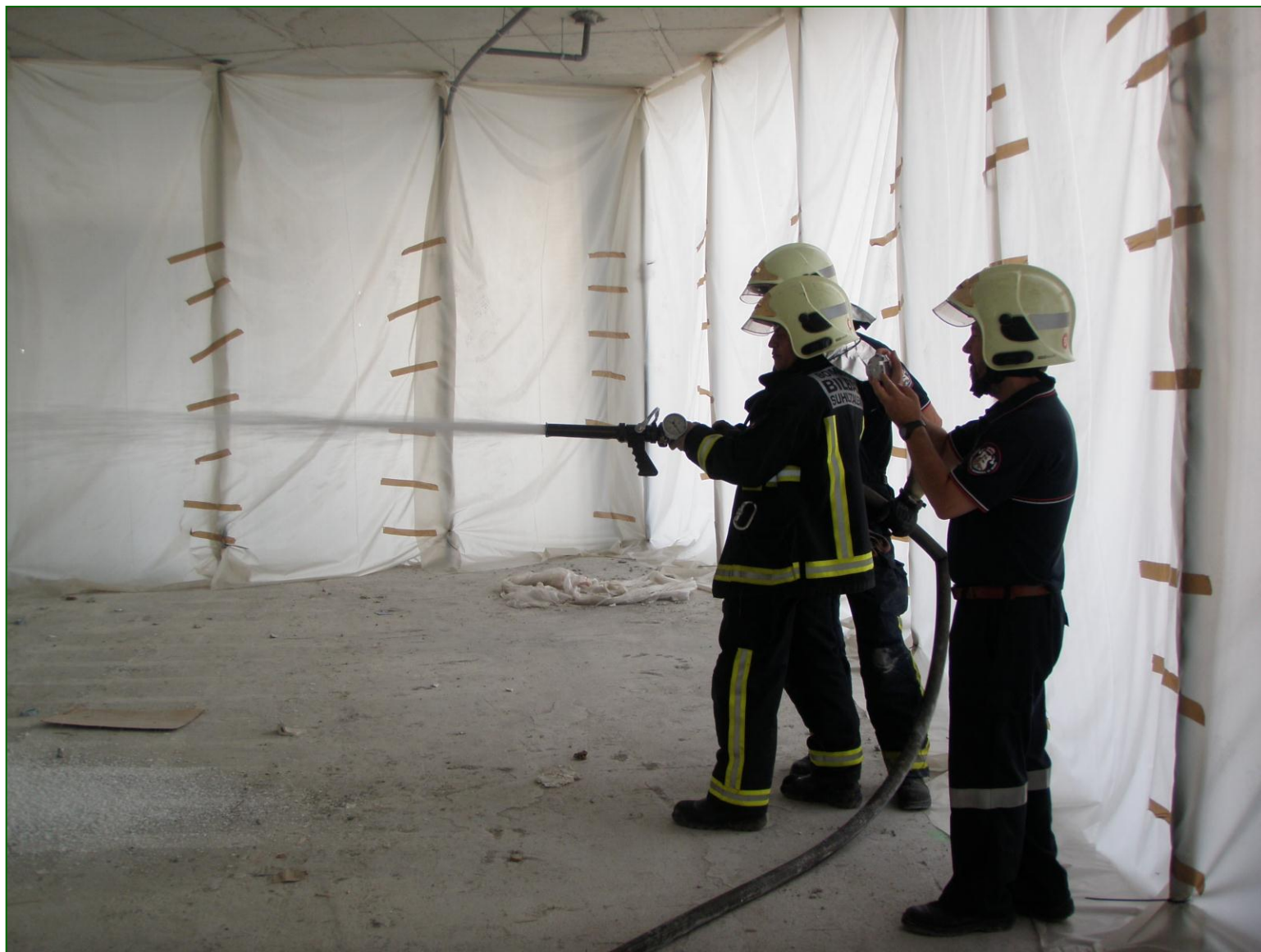
Realización de la prueba de la columna seca con espuma
