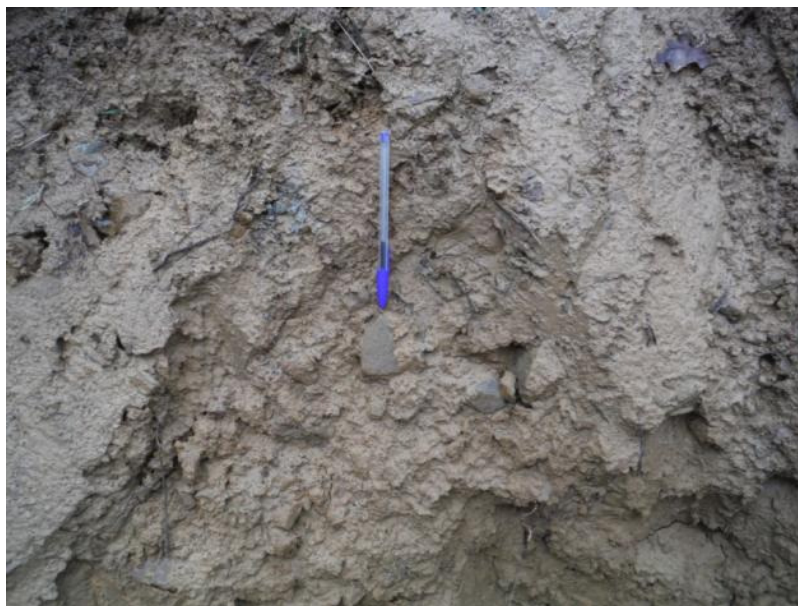
Depósito Coluvial excavado para el acceso al sondeo S-3 del tramo de la Variante de Altzola.
