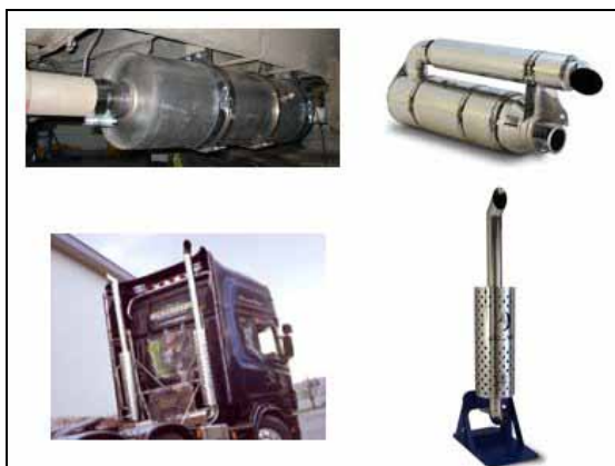
Figura 4.1. – Filtros de partículas en diferentes tipos de vehículos: autobuses, camiones, ...
