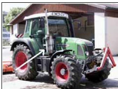
Figura 4.9. – Filtros de partículas instalados en maquinaria agrícola y de obras
