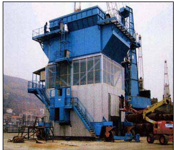
Figura 4.6. – a) Descarga de material sobre tolva; b) Tolva ecológica del Puerto de Pasajes reduce las emisiones entre el 80 y 90%
