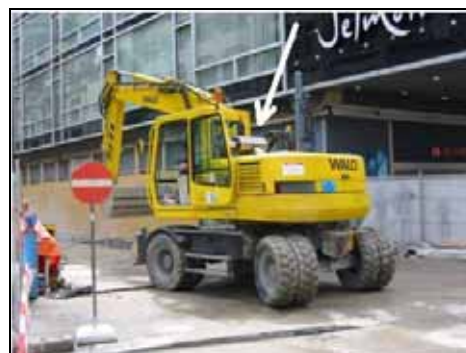
Figura 4.9. – Filtros de partículas instalados en maquinaria agrícola y de obras
