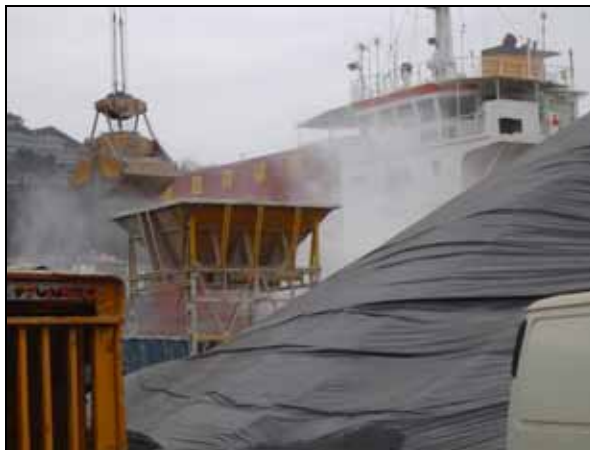
Figura 4.6. – a) Descarga de material sobre tolva; b) Tolva ecológica del Puerto de Pasajes reduce las emisiones entre el 80 y 90%
