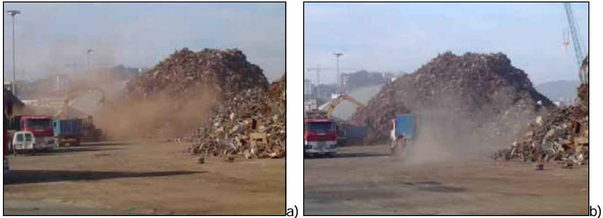
Figura 4.7. – a) Emisión de material particulado en las actividades de carga/descarga; b) Resuspensión debido al paso de vehículos por viales sucios
