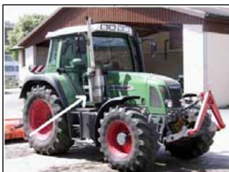
Figura 4.5. – Filtros de partículas instalados en maquinaria agrícola y de obras
