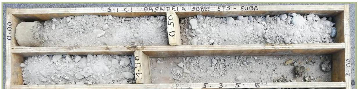
En esta capa se ha realizado un ensayo SPT, donde se ha obtenido un valor N=8 en 30 centímetros de ensayo.
