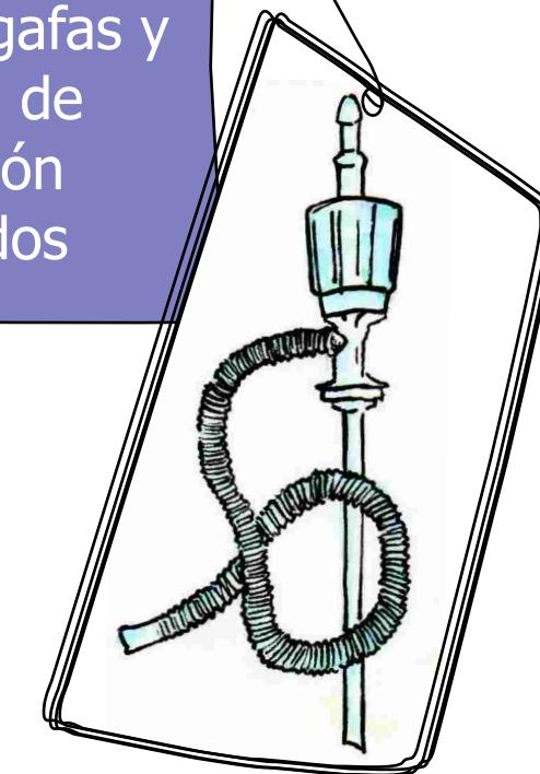
Realiza un mantenimiento apropiado de la máquina de limpieza en seco: extrae los residuos del destilador en frío al inicio de la jornada; limpia diariamente el cazabotones y el filtro de pelusa y guarda los residuos en un recipiente herméticamente cerrado. Para todo esto, usa EPI's y ventila la zona
