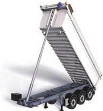
Los semirremolques basculantes representan la mejor opción para el transporte de la gran mayoría de materiales a granel dada la rapidez con la que efectúan las descargas, su simplicidad y robustez. No obstante, la maniobra de basculación puede ser peligrosa y ocasionar graves consecuencias al conductor/a y a las personas trabajadoras próximas si no se adoptan las medidas de prevención adecuadas.
