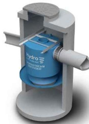
Se instalará uno por cada colector de la margen izquierda, es decir, en el colector 1 y el colector 2. Dado que los colectores son profundos y estos elementos aún bajan cerca de 2 metros respecto de la lámina de agua, se proyectan recintos de tablestacas para ejecutar la excavación necesaria para albergar estos elementos.
