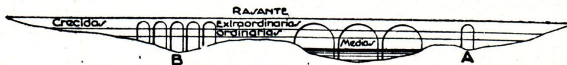
Figura 67.- Esquema habitual de un puente construido en una llanura (J.E. Ribera, 1936)
