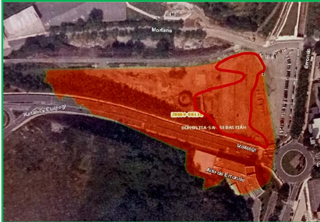
Figura 2. Zonificación en el emplazamiento de la antigua Fábrica Municipal de Gas y trazado de la excavación a realizar.
