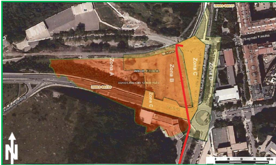
Figura 3. Zonificación en el emplazamiento de la antigua Fábrica Municipal de Gas y trazado de la excavación a realizar.
