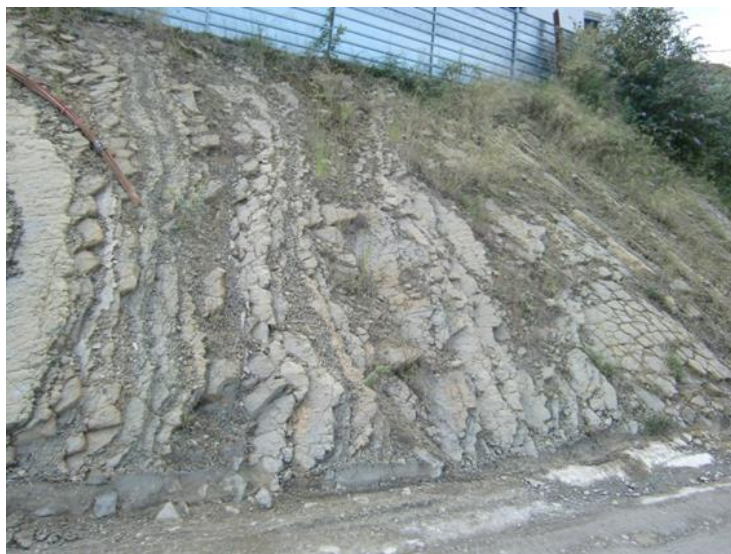
Figura 3 Detalle flysch (litotipo F). Alternancia de margas y bancos cm de calcarenitas. (GM III-IV). Afloramiento, estación geomecánica EG-04 (Fuente: SENER 2011).
