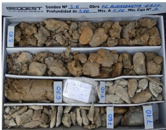
Figura 5 Rellenos antrópicos (Rx) hasta los 7,10 m, sobre el sustrato rocoso perforado en seco. Sondeo S-6 (Prof. de 5,10 a 7,70 m) (Fuente: FULCRUM 2016).
