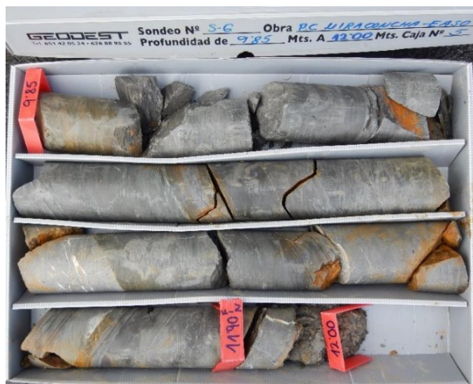
Figura 4 Testigos en flysch detrítico-calcáreo (litotipo F). Sondeo S-6 (Prof. de 9,85 a 12,00m) (Fuente: FULCRUM 2016).
