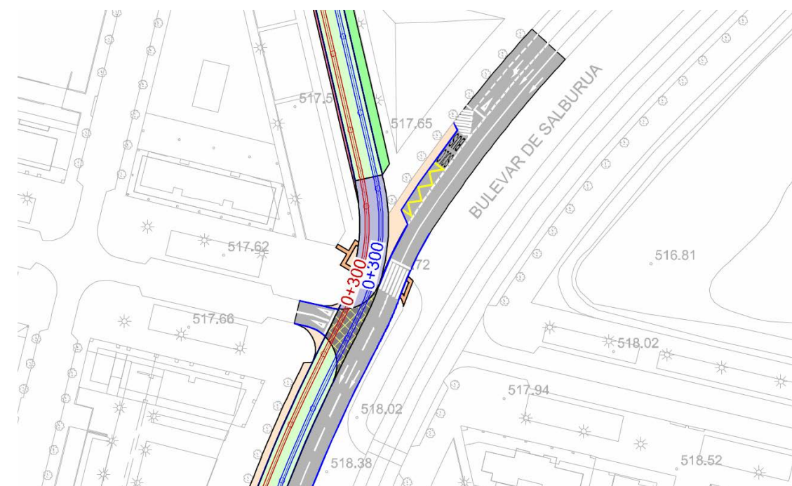
Planta estado futuro de la intersección del Bulevar de Salburua con el Paseo del Aeródromo
