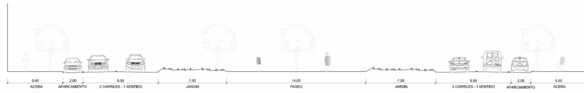
Sección transversal existente de la Avenida Juan Carlos I a la altura de la futura parada
