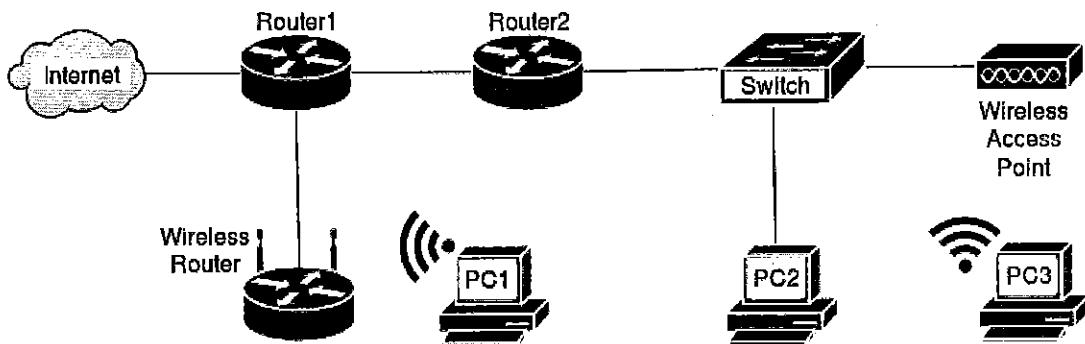
Se pide diseñar un esquema de direccionamiento con IPs estáticas apropiado para el diagrama de red de la figura, utilizando para ello el rango de direcciones privadas 192.168.0.0/16 de la forma que consideres adecuada y suponiendo que Router1 recibe una IP pública de Internet mediante DHCP.
