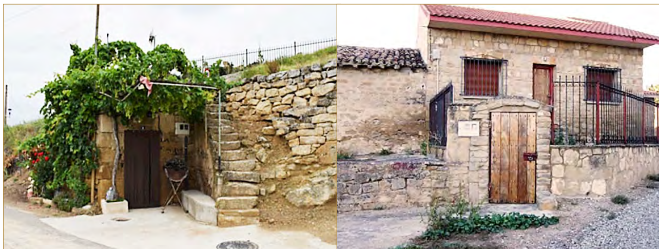
▲ Figura 34. Pequeñas estructuras para controlar el acceso al pozo de nieve y aislar térmicamente el conjunto en Rioja Alavesa, a modo de entrada a calaos-bodegas de vino. A la izquierda en Moreda de Álava y a la derecha en Oyón.
