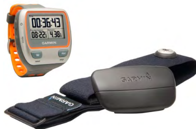
Figura 7.6. Pulsómetro Garmin Forerunner 310XT. Pulsómetro con navegador GPS integrado. Ofrece la posibilidad de obtener información sobre distancias, velocidades, ritmo y frecuencia cardiaca en diferentes actividades. Es sumergible hasta 50 metros, aunque el sistema GPS no mide de forma fiable debajo en el agua. Permite la transferencia de datos a aplicación móvil Garmin Connect®. Una opción popular entre los triatletas.
