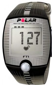
Figura 7.5. Pulsómetro Polar FT1. Pulsómetro con banda pectoral de emisión codificada. Funciones de zona objetivo manual y automática con alarma sonora. Uno de los pulsómetros de primeras marcas más baratos del mercado
