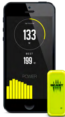
Figura 7.24. Dispositivo BEAST. Acelerómetro externo que se puede situar en una banda sobre brazos o piernas, o bien a través de un imán sobre la pesa o máquina con la que estemos entrenando. A través de Bluetooth podemos volcar datos a tiempo real y verlos en el Smartphone. La App no cuenta con registros históricos de entrenamiento. Así, para acceder a las estadísticas en necesario registrarse en su web a través de internet
