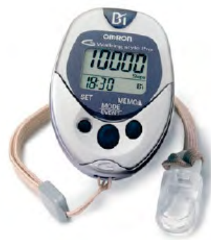
Figura 7.4. Walking Style Pro HJ-720-IT-E2. Podómetro con sensor de aceleración biaxial, que permite la conexión mediante un USB para la descarga de datos a PC. Se acompaña de un software (ver apartado Imágenes y Videos) que permite la integración de los datos de actividad física con el registro de tomas de presión arterial, de forma manual o con descarga de determinados modelos de tensiómetros de la misma marca. Puede utilizarse como elemento diagnóstico, permitiendo el programa la inclusión de múltiples usuarios
