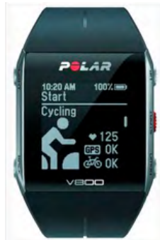
Figura 7.7. Pulsómetro Polar V800. Pulsómetro con GPS y acelerómetro integrados. Permite medir la frecuencia cardíaca tanto en tierra como en el agua. Mediante su GPS podemos medir distancias, velocidades y ritmos. Si bien el GPS no da buena señal en el agua, el acelerómetro permite reconocer automáticamente el estilo de nado, medir en el agua el número de brazadas, hacer el recuento de metros y velocidad e incluso calcular el Swolf (tiempo más brazadas). Además, calcula el número de pasos y las horas diarias de sueño
