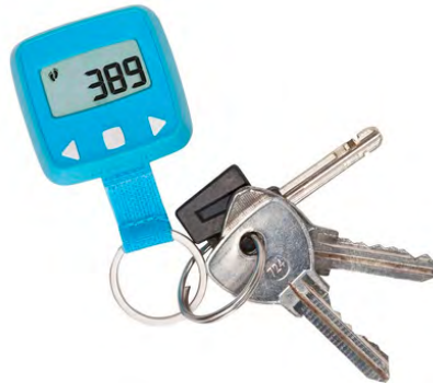
Figura 7.3. Podómetro acelerómetro OnWalk 100 Geonate. Podómetro con sensor de aceleración triaxial. Mide simplemente pasos y distancias. Uno de los modelos de más sencillo uso y prácticos para su transporte. Solo indicado para medir actividad durante caminatas
