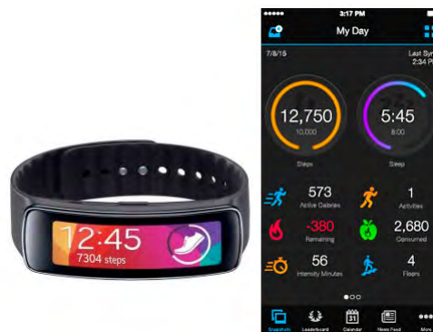
Figura 7.9. Pulsera Samsung Gear Fit. Pulsera de actividad de gama alta con pantalla de visualización que integra pulsómetro, acelerómetro y altímetro barométrico. Permite gracias a ello medir actividad diaria en pasos, calorías quemadas y monitoriza la frecuencia cardíaca. Permite medir los escalones subidos al día y las horas de sueño. Es sumergible en el agua. Mediante conexión bluetooth se puede sincronizar con el móvil para pasar los datos de actividad y llevar un registro de la misma. Se puede sincronizar con la aplicación My fitness pal para llevar un recuento de las calorías consumidas y quemadas día a día
