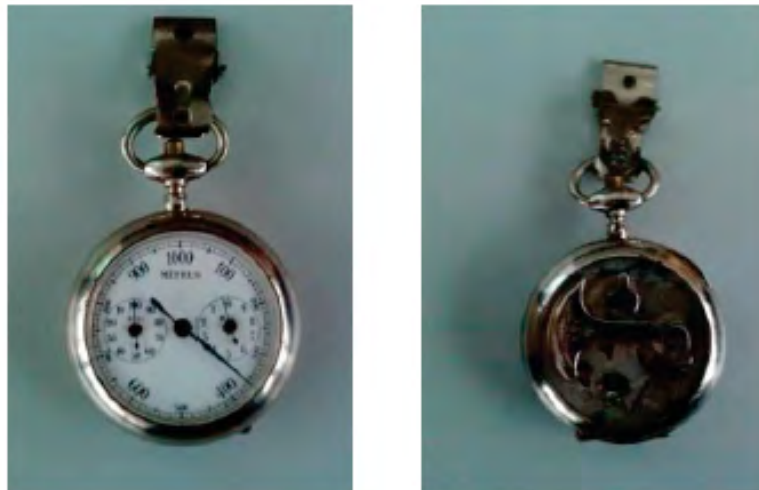
Figura 7.1. Podómetro de mediados del S.XX. Registro de la distancia recorrida mediante un sistema mecánico pendular y una serie de engranajes parecidos a los de un reloj de pulsera
