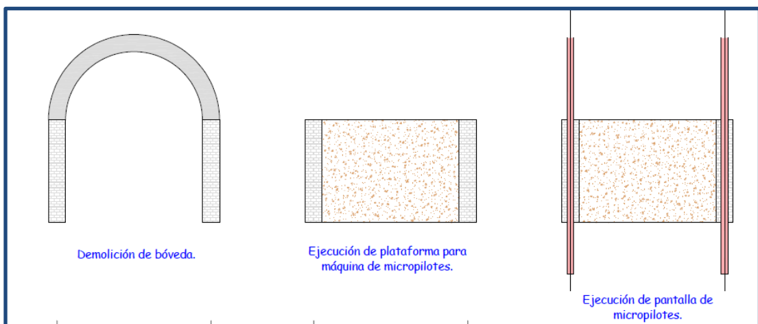
Figura 15. Esquema de ejecución de plataforma para máquina de micropilotes
