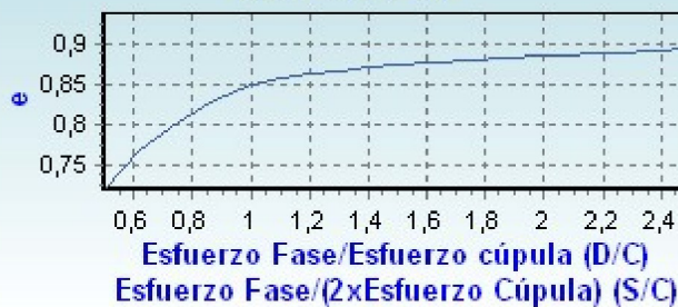
Esfuerzo horizontal que soportan los apoyos con cúpula CO h=4,3 b=4,4
