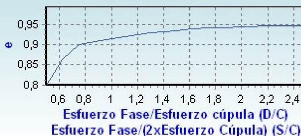
Esfuerzo horizontal que soportan los apoyos con cúpula AG h=3,7 b=2
