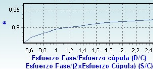
Esfuerzo horizontal que soportan los apoyos con cúpula HA h=2,7 b=1,4
