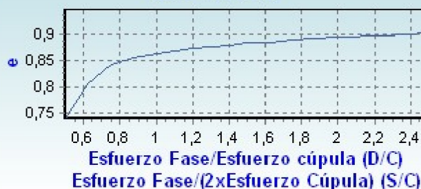
Esfuerzo horizontal que soportan los apoyos con cúpula CO h=4,3 b=3,3
