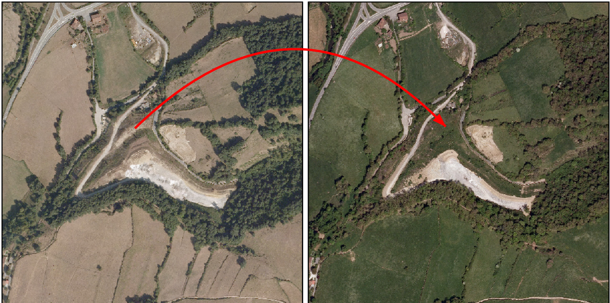
Figura 17. Muestra de la revegetación llevada a cabo en la zona colmatada. Comparación entre los años 2006 y 2009.
