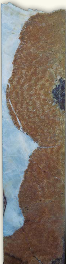
Testigo de un sondeo realizado en la zona de Gallarta para delimitar la extensión del yacimiento de siderita.
