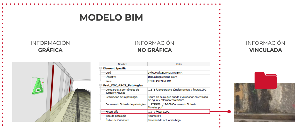
Figura 7: Ejemplo de los 3 tipos de información para una Patología de Fisura de Muro en un Túnel.
