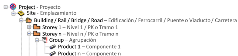
Figura 5: Árbol de Estructura de un Modelo IFC.
