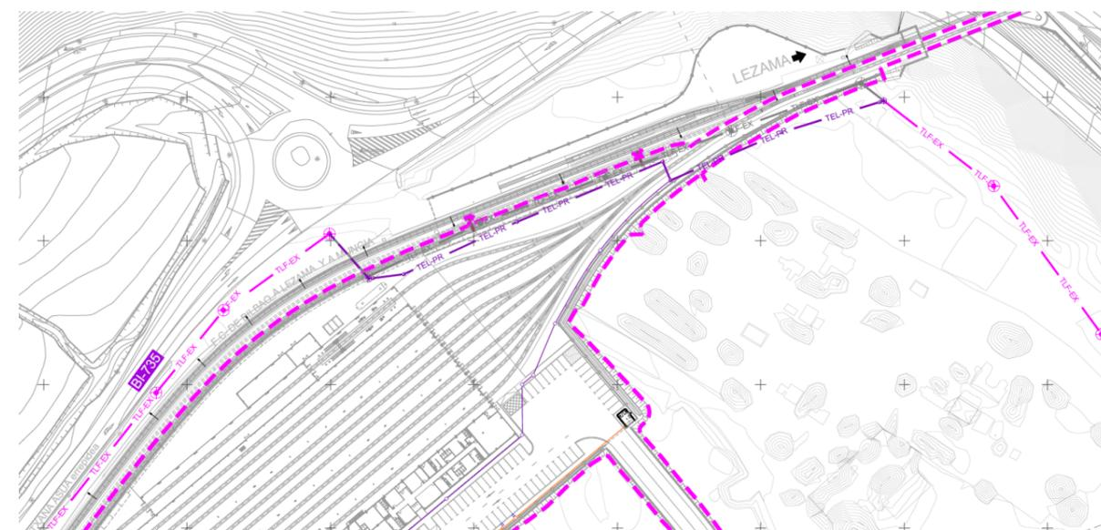
Figura 5: Soterramiento de la línea telefónica afectada
