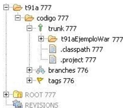
Desde esta misma perspectiva y debido, por un lado, a la flexibilidad ofrecida por Subversion y, por otro, al buen funcionamiento del plug-in Subversive se podrá modificar la estructura definida para este repositorio desde la perspectiva *SVN Repository Exploring*.
