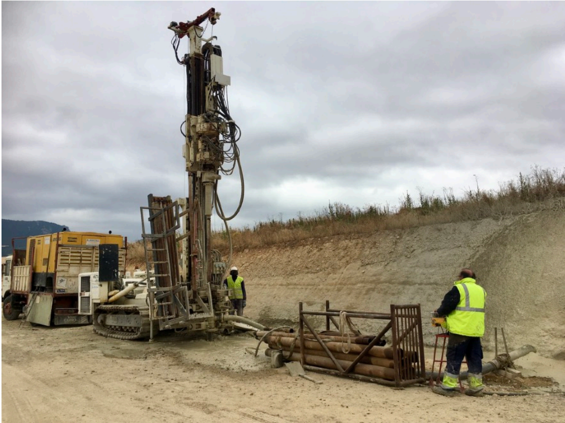
Fig. 5.1.- Maquinaria de perforación a rotopercusión tipo para perforar Artika-A.
