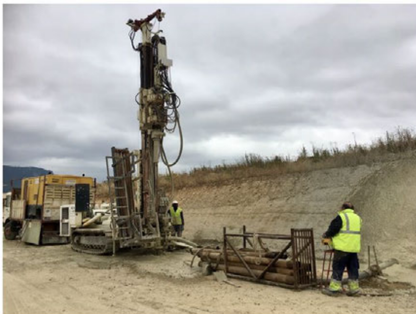
Fotografía 1. Maquinaria de perforación a rotopercusión tipo para perforar Artika-A.
