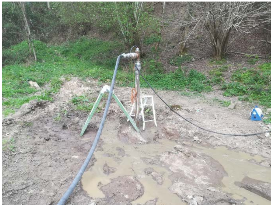
Fig. 5.1.- Equipamiento en sondeo Artika-1 para la realización del ensayo “air-lift”.
