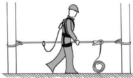
b) Línea de anclaje provisional de cinta
