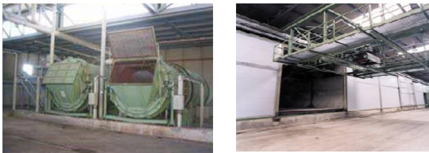
Figura 15. Reactor dinámico de compost (cerrado) y túneles dinámicos.
