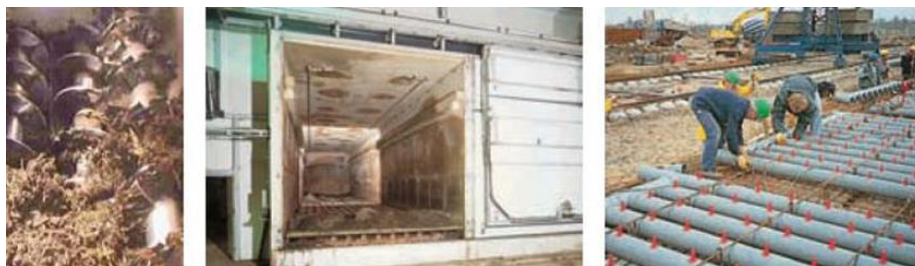
Figura 15. Reactor dinámico de compost (cerrado) y túneles dinámicos.
