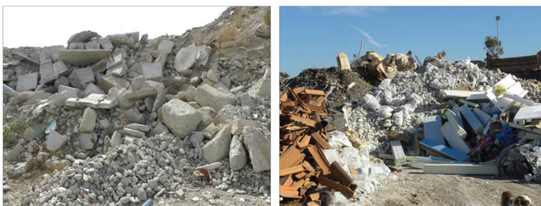
RCD's Limpios (Izq.) y RCD's mezclados (Dcha.) acopiados en la zona de descarga antes de la separación de elementos reutilizables (plásticos, madera, etc.) y otros elementos contaminantes
