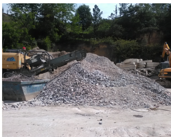
Acopio de árido reciclado
