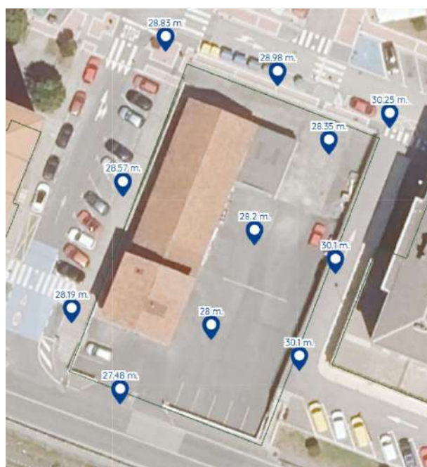
Estado actual. Rasantes del terreno
