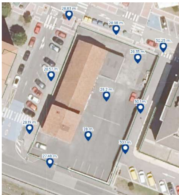
Estado actual. Rasantes del terreno
