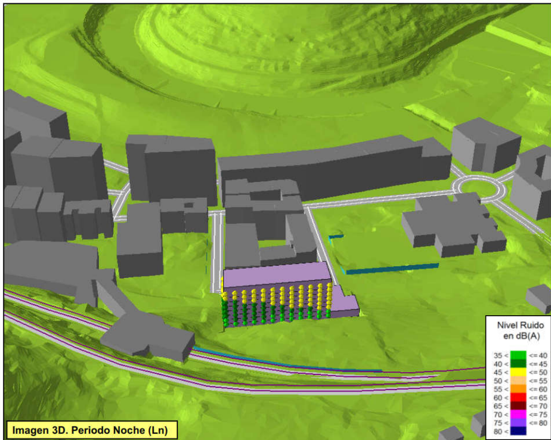
Niveles de ruido en fachada 3D. Ln. Escenario futuro con Pantalla de 2m
