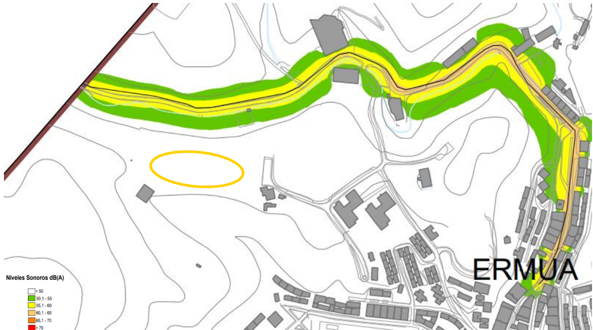
Figura 4: mapa de ruido de carreteras de Ermua en la zona de estudio. Período noche.
